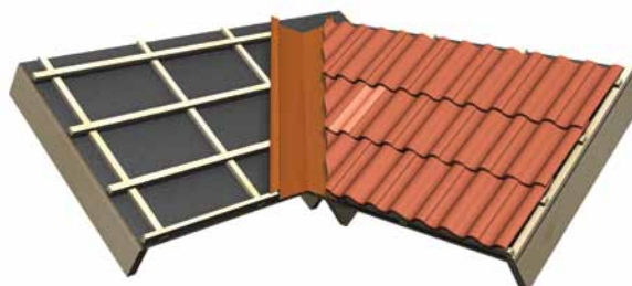
Bild 15. Vid vinkelrännor används halvpannor för att undvika småbitar (endast 2-kupiga). Halvpannan är markerad på bilden. Undvik små skurna bitar som är svåra att fästa. Rita på taket - skär på marken - spola pannorna med vatten direkt efter skärning!
