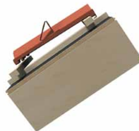
Bild 16. Om man har problem med snöras vid vinkelränna kan man montera snökrokar. Snökroken är ett lättmonterat komplement till ditt snöresskydd. Åtgång ca 3-4 st/m 2 .
