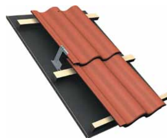
Bild 8. Clipset placeras så att både undre och övre pannan låses med samma clips.
