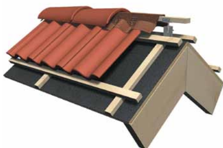
Bild 13. Benders nock och valmtättningsrulle är lätt att montera. Rulla ut en längd på nockplankan, spika eller häfta fast den. Ta sedan bort skyddstejpen på undersidan av rullen och tryck fast och forma mot takpannorna.
