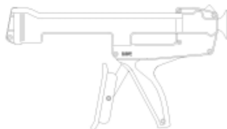
Kraftlim Pistol H 245 Proffspistol för trög massa utvecklar 5 kN (500 kg tryck). Antidroppfunktion i handtaget. Ställskruv för förlängd livstid. För patroner även där mixermunstycket ej är centrerat.
