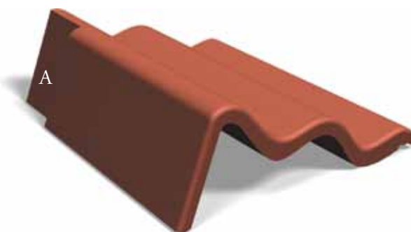
Ovan: Gavelpanna vänster. Klipp, se A på bilden ovan. Klipp är den yta där pannorna går omlott, finns i 88 och 110 mm klipp.
